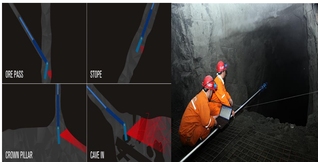
15 Сурет – Жерасты қазбаларын сканерлеу
